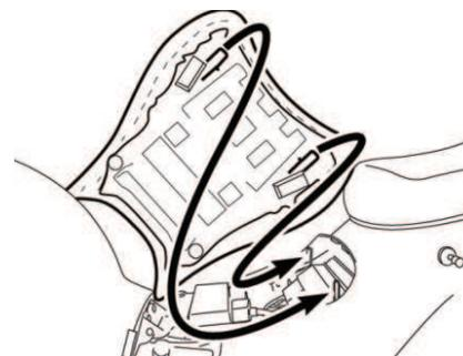
Para reinstalar o assento, deslize os ganchos do assento para dentro dos encaixes nos chassi e aperte os parafusos seguramente.
