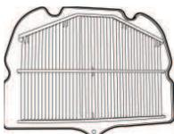
Inspeção a condição do filtro de ar. Troque o filtro de ar periodicamente.
