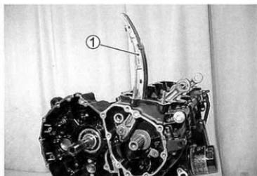
**CAM CHAIN DRIVE SPROCKET**
