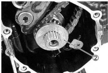
**CAM CHAIN DRIVE SPROCKET**
