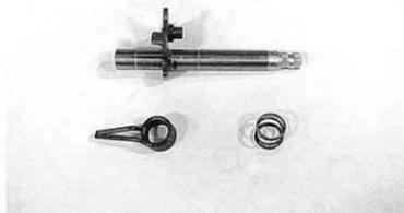
**GEARSHIFT SHAFT/GEARSHIFT ARM REASSEMBLY**
